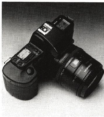
Kontrolpanelet og funktionsknapperne er anbragt overskueligt og fingerrigtigt på det forholdsvis kompakte kamerahus. Sammen med 28-70 mm zoomen udgør det en velafbalanceret enhed.
