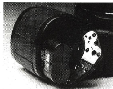
Batterigræbet giver valgfrihed mellem lithium- og AA-batterier.
